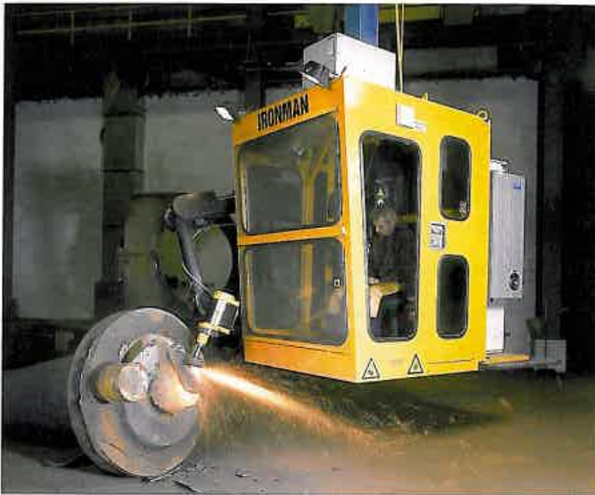
Bild 2: Mit dem Gussputzsystem Ironman lassen sich Gussteile jeder Größe bearbeiten.
